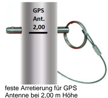
Aufnahme von ZEISS KTR 1 mit 5/8", KH = 100 mm
